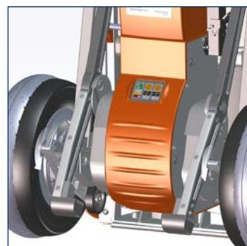
**Sicherheitsbremsen deaktivieren.** Dazu Bremshebel mit dem Fuß nach unten drücken. Verschleiß und Beschädigung durch Fahren mit aktivierten Sicherheitsbremsen!
