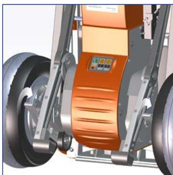
Sicherheitsbremse auf beiden Seiten aktivieren. Dazu Bremshebel mit dem Fuß nach oben drücken.
