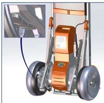
Bremsbeläge der Sicherheitsbremsen regelmäßig auf Beschädigungen und Abnutzung prüfen.
