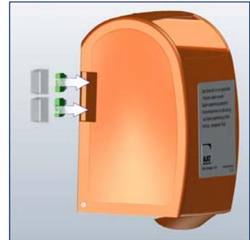
Neue Sicherungen 40 A einsetzen und Kappen aufsetzen.
