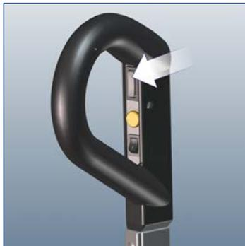
AUF-/AB-Schalter Richtung AUF drücken, bis Schaufel ca. 10 mm über Ladekante.
