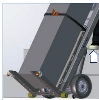
Rückwärts ganz an Stufe heranfahren. 2 bis 3 Stufen nach oben gehen.
