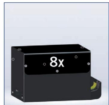
Schrauben der Akkuabdeckung lösen (8 Stück).
