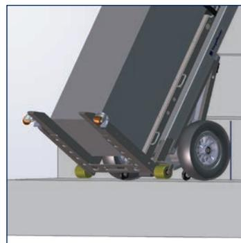
CargoMaster nach vorne schieben bis Sicherheitsbremsen greifen. Ab Step 7 wiederholen.
