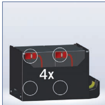
Steckkontakte herstellen. Kabel so verlegen, dass sie nicht gequetscht werden.
